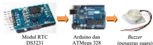
Gambar 7 Sistem Bel Sekolah Otomatis Yang Diusulkan
