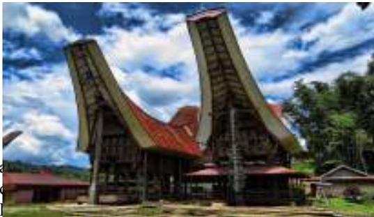
panggung dengan tiang-tiang penyangga bulat yang berjajar menyokong tegaknya bangunan. Tiang-tiang yang menopang lantai, dinding, dan rangka atap tersebut tidak di tanam di dalam tanah, melainkan langsung ditumpangkan pada batu berukuran besar yang dipahat hingga berbentuk persegi. Dinding dan lantai rumah adat Tongkonan dibuat dari papan-papan yang disusun sedemikian rupa.
